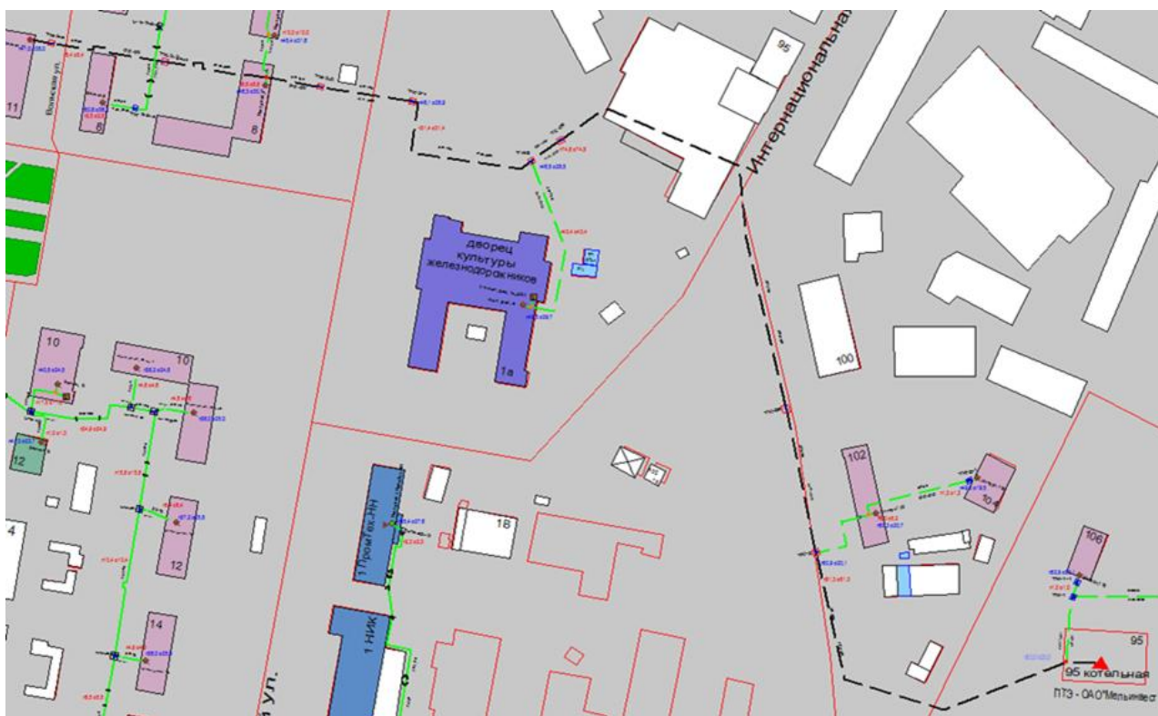
Рисунок Ошибка! Текст указанного стиля в документе отсутствует..125 – Трассировка теплопровода от котельной ОАО «Мельинвест» по ул. Интернациональная, д. 95 до конечного потребителя «ПТ-Вольск,11»
