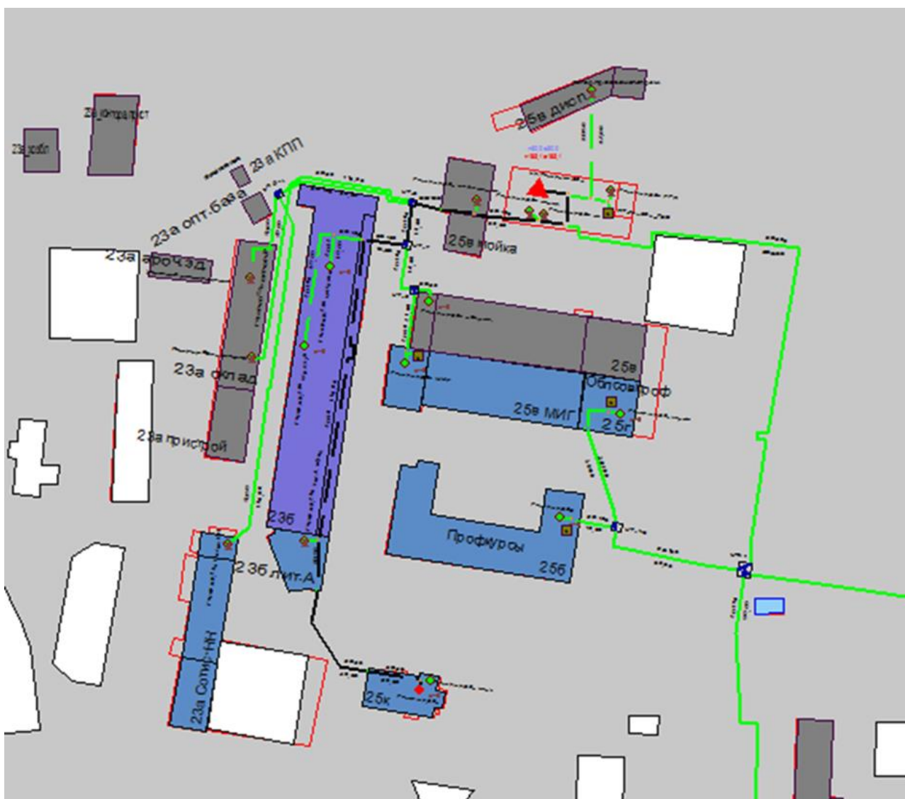
Рисунок Ошибка! Текст указанного стиля в документе отсутствует..57 – Трассировка теплопровода от котельной АО «Теплоэнерго» «Дворец спорта» по пр. Гагарина, д. 25Е до конечного потребителя «ПТ-Гагар.пр,25к»
