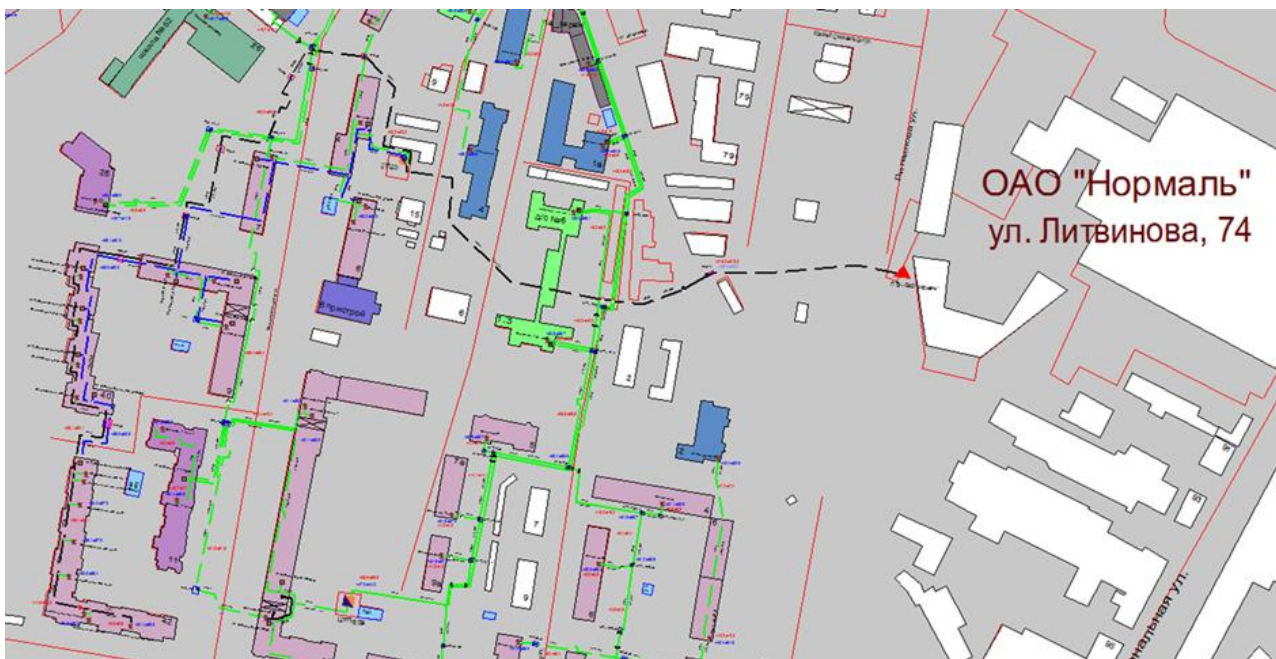
Рисунок Ошибка! Текст указанного стиля в документе отсутствует..107 – Трассировка теплопровода от котельной ОАО «Нормаль» по ул. Литвинова, д. 74 до конечного потребителя «ПТ-Октяб.рев,42 ввб»
