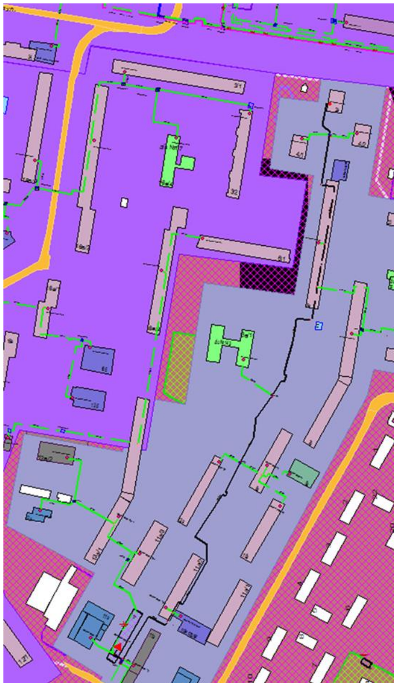
Рисунок Ошибка! Текст указанного стиля в документе отсутствует..109 – Трассировка теплопровода от котельной ООО «Генерация тепла» по ул. Мончегорская, д. 11 до конечного потребителя «ПТ-Мончегорская,2а»
