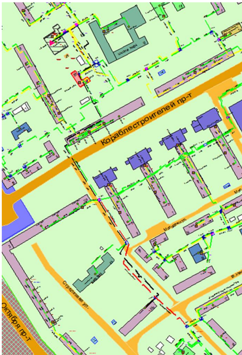
Рисунок Ошибка! Текст указанного стиля в документе отсутствует..63 – Трассировка теплопровода от котельной АО «Теплоэнерго» по ул. Баренца, д. 9А до конечного потребителя «ПТ-Иван,55а»
